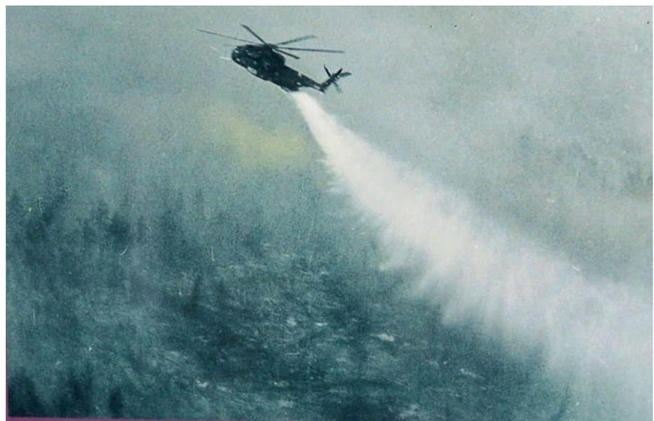
1975 9 CH-53 bekämpfen einen verheerenden Flächenbrand in der Lüneburger Heide. Das Löschwasser wird direkt aus dem Laderaum durch die Heckklappe über dem Brandherd verklappt.
