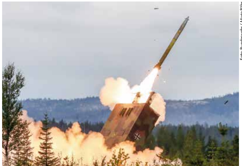
Der Raketenwerfer MARS II bekämpft Ziele in einer Entfernung von bis zu 84 Kilometern.
