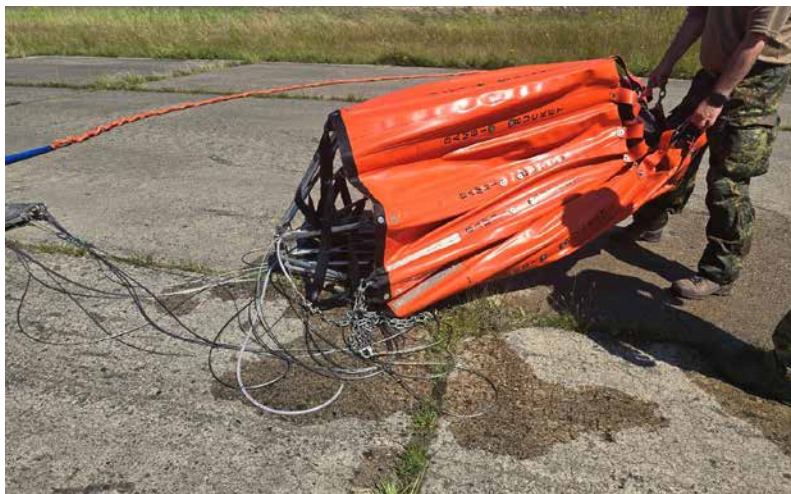
Nachbereitung – ein Soldat hebt den Bambi Bucket an einem Ende an, um das restliche Wasser abzulassen.
