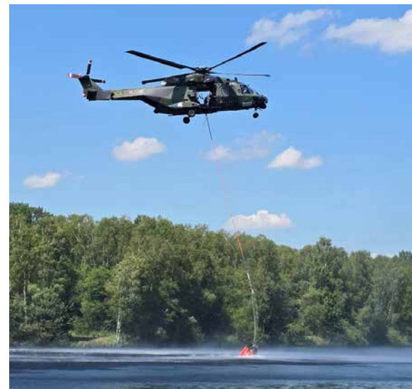
Ein NH90 schwebt über einem See und senkt den Bambi Bucket, um ihn mit Löschwasser zu füllen – ein präzises Manöver in Aktion.
