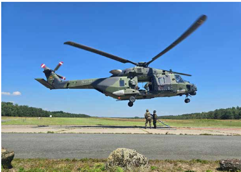
Ein NH90 schwebt knapp über dem Boden, während Soldaten darunter die Longline und den Bambi Bucket sicher am Hubschrauber befestigen.
